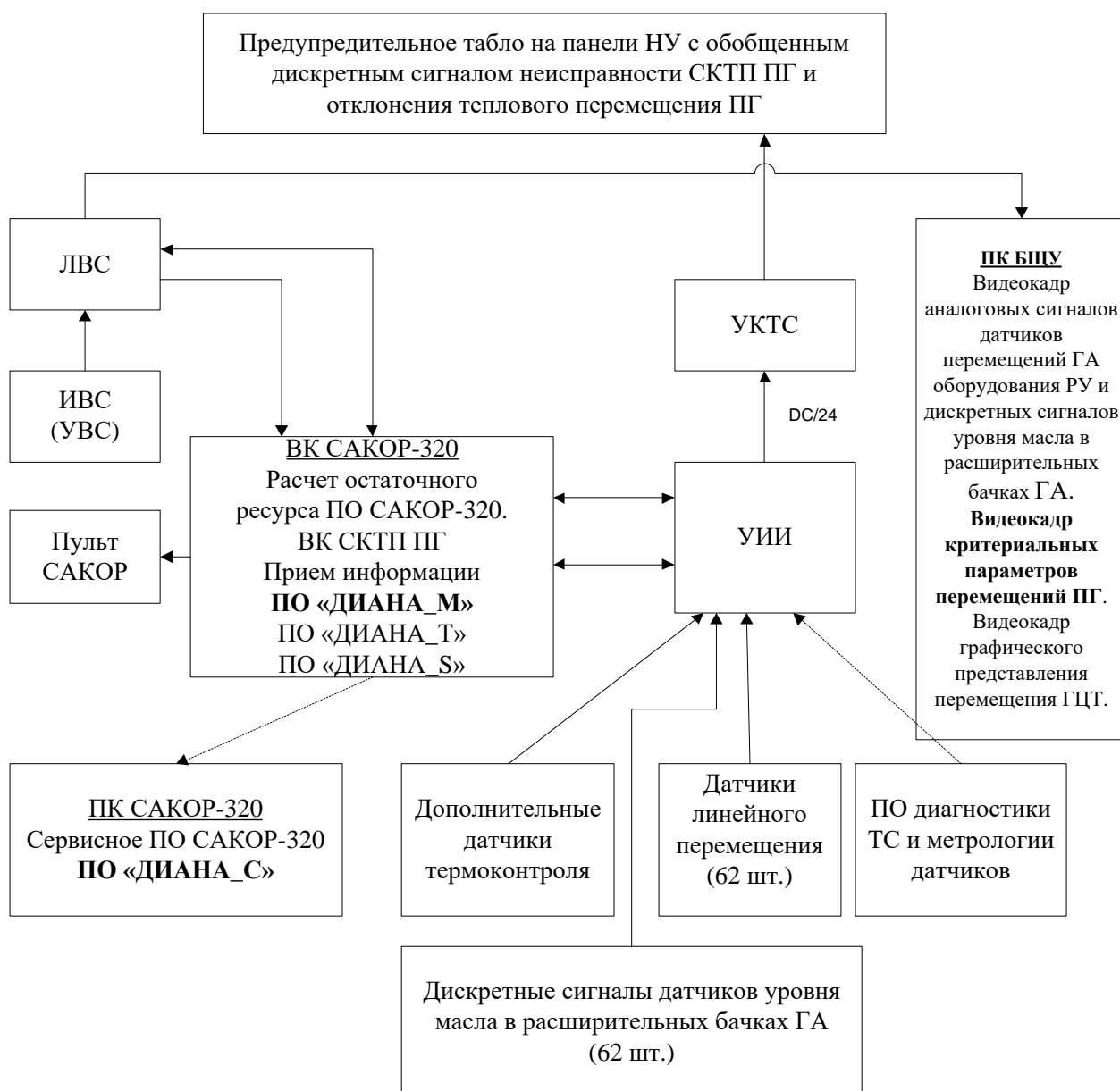
Рисунок 1 – Принципиальная схема передачи информации на ВК САКОР-320
